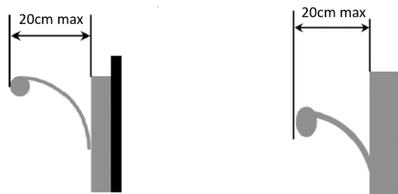
Schématisme de la saillie autorisée pour l'implantation de l'éclairage sur les dispositifs publicitaires
